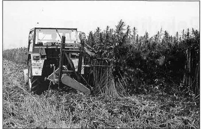
Bild 3: Zweiebenen-Schneidwerk im Einsatz
