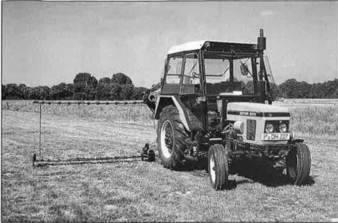
Bild 2: Zweiebenen-Schneidwerk
