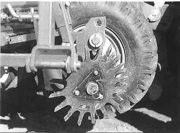
Bild 1: Trashwheel an einer Einzelkornsämaschine
