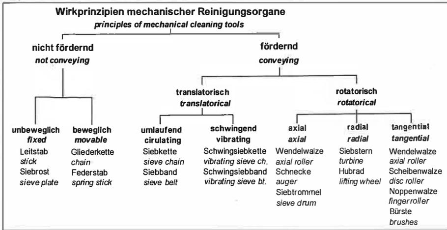
Bild 1: Mechanische Reinigungswerkzeuge in Zuckerrübenerntemaschinen
