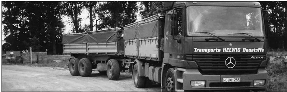
Bild 2: Lkw-Zug mit 2-achsiger Zugfahrzeuge und dreiachsiger Anhänger jeweils mit Kippaufbau
