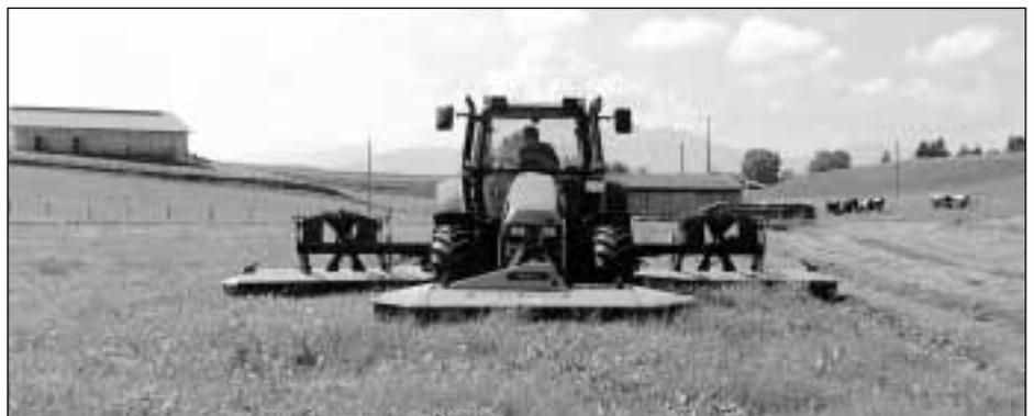
Die Mähwerkskombination KM 5.90 von Deutz-Fahr in "Schmetterlingsbauweise" (zwei Mäheinheiten im Heck plus ein Frontmäherwerk) ermöglicht eine Schnittbreite von 8,50 m.
