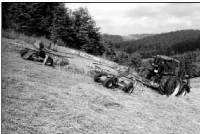
*Gute Geländeangepassung des Stoll-Seitenschwaders R 1405 S durch kardanische Kreiselaufhängung*
