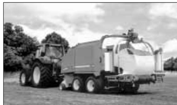
*Das Einstretchen von Rund- und Quaderballen ist ausgereift. Zur Verbesserung der Arbeitswirtschaft werden von mehreren Anbietern die Arbeitsgänge Pressen und Stretchen in einer Maschine kombiniert, hier die Kombipresse 678 von John Deere. Dadurch wird ein Arbeitsgang bei der Ballensilagebereitung eingespart.*
