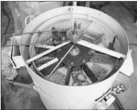
Bild 2: Prototyp des mechanischen Schälers
