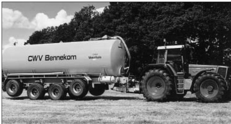
*Bild 2: Güllefahrzeug mit mobiler Wägetechnik erleichtert den Nachweis der ausgebrachten Güllemenge (Foto Archiv)*
