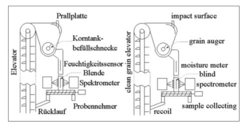
Fig. 1: Measurement-Unit
