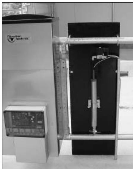
Bild 2: Messzylinder des Automatischen Trinkwassermesssystems (ATS) mit Magnetventil von Förster Technik
