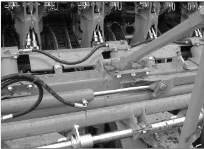
*Bild 2: Grimme bietet für seinen Maxtron 620 eine vollhydraulische Reihenweitenverschiebung von 45 auf 50 cm per Knopfdruck (Werkbild Grimme)*
