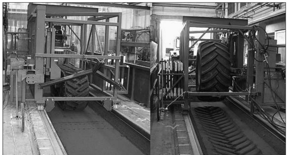
Bild 1: Fahrwerkstestrahmen mit einer Raupe (links) vor und einem Reifen (rechts) nach der Überfahrt
