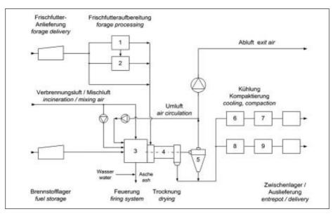
Bild 1: Fließbild einer Grünfutter-Trocknungsanlage
