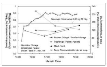
Bild 2: Dioxinkonzentrationen im Grünfutter und Trommeleintrittstemperatur, gemessen während eines Anfahrvorganges einer Grünfuttertrocknungsanlage
