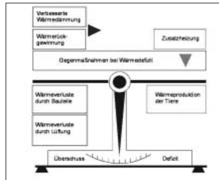
Bild 1: Wärmebilanz-Waage mit Ausgleichsmöglichkeiten
