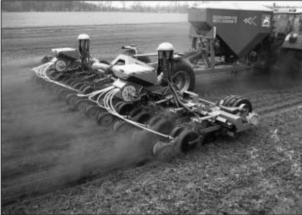
*Bild 2: Bei seinem Einzelkornsägerät EDX 9000-T trennt Amazone Kornvereinzellung und Ablagesystem und ermöglicht so Arbeitsgeschwindigkeiten bis 15 km/h (Werkbild)*
