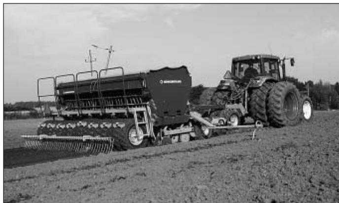
*Bild 1: Auf der Agritechnica stellt Kongskilde eine neue Serie gezogener Universaldrillmaschinen unter der Bezeichnung „FlexiDrill“ vor (Werkbild)*
