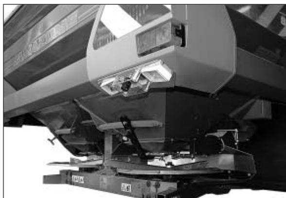
*Bild 3: Das Kamerasystem Argus von Amazone dient zur berührungslosen Abstimmung der Streufächer, um die Einstellwerte für die Querverteilung automatisch zu ermitteln (Werkbild)*
