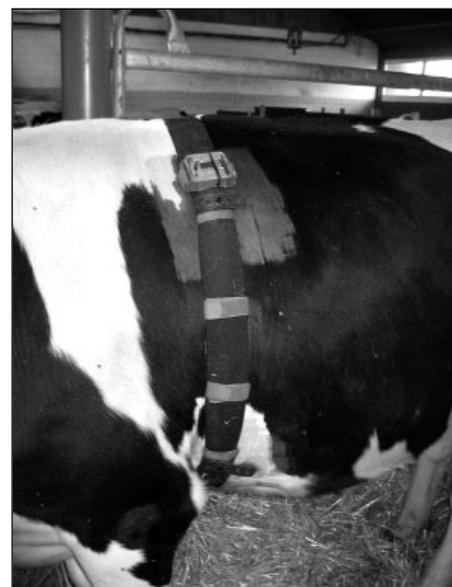
Bild 1: Gurt mit zwei Elektroden und Herzfrequenzmonitor
