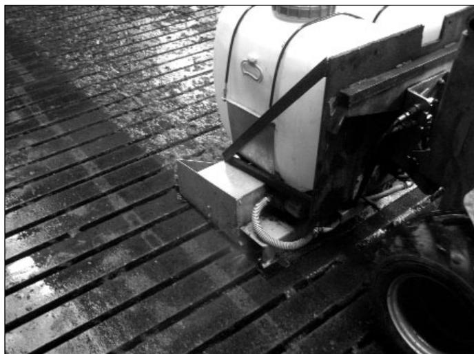
*Bild 2: Westermann präsentiert mit dem Cleanmeleon 3 einen modular aufgebauten Spaltenbodenreiniger, der wirksam Spaltenoberfläche und -zwischenraum reinigt (Goldmedaille)*
