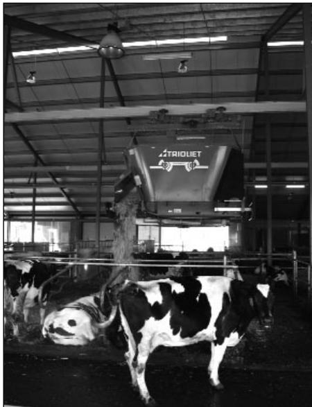
Bild 1: Mit dem Triomatic-System von Trioliet können die Liegeboxen vollautomatisch eingestreut werden
