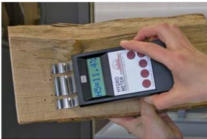
Messgerät, das nach dem dielektrischen Prinzip arbeitet
