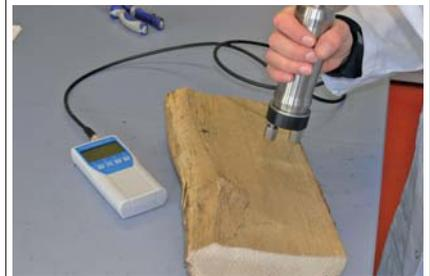
Messgerät, das nach dem Prinzip der elektrischen Leitfähigkeitsmessung mit Einschlagelektroden arbeitet
