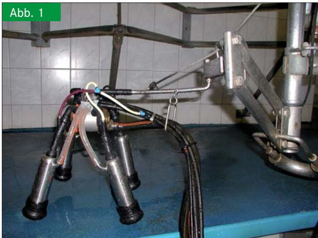
Versuchsaufbau des AktivPuls-Melkzeuges. Foto: Sagkob
