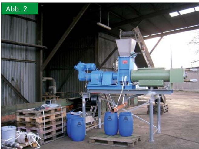
Mithilfe von Schneckenpressen kann der Trockenmassegehalt der Silage mit relativ geringem Primärenergieaufwand gesteigert werden. Foto: ATB
