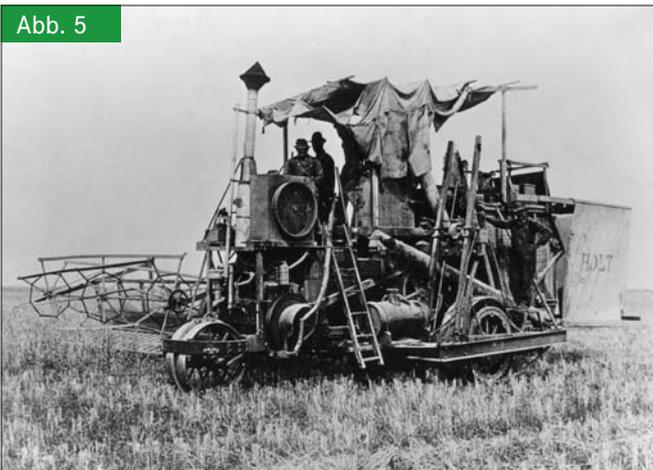
Erster von einem Benzinmotor angetriebener selbstfahrender Mähdrescher, gebaut von der Holt Manufacturing in Stockton, USA
