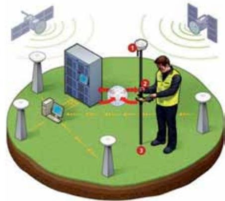
RTK-Netzwerk – schematisiert, 1 verbinden, 2 korrigieren, 3 messen
