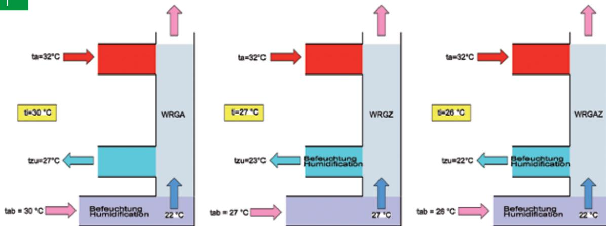
Schematische Darstellung der verschiedenen WRG-Varianten mit adiabatischer und/oder diabatischer Kühlung
