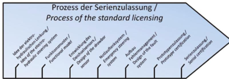
Wichtige Entwicklungsschritte der elektrohydraulischen Lenkanlage
