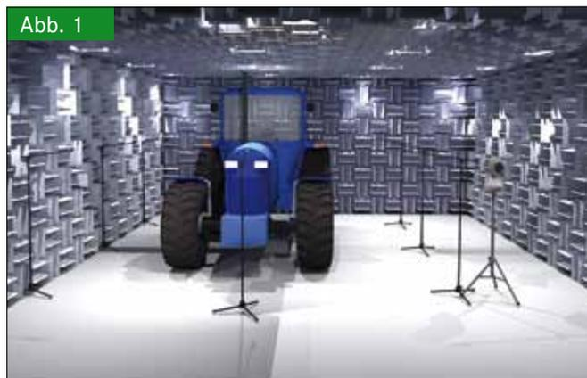
Beispielhafter Messaufbau im schallreflexionsarmen Messraum (Mikrofone, Kunstkopf-Messtechnik)
