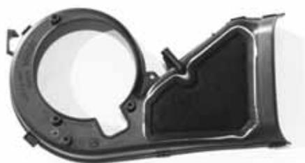
Klimaanlage, Absorptionspads zur Reduzierung breitbandiger Strömungsgeräusche
