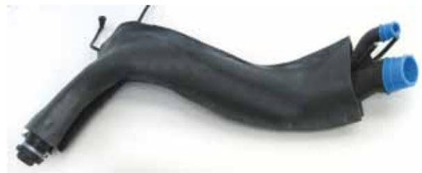
Kraftstoffschlauch mit PE-Schaumtülle zur Wärmeisolation
