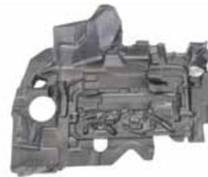
Polyurethan-Abdämpfung auf dem Motorblock, genaue Anpassung an die Oberflächenkontur des Motors zur Verringerung der Schallabstrahlung des Zylinderkopfs bzw. Ventiltriebs
