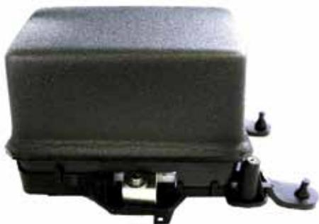
Vakuumgezogene Batterie-Isolation als Überhitzungsschutz
