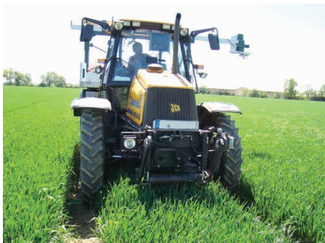
Abbildung 2: Testprototyp des Kamerasensors (ATB) bei den Feldversuchen, Betriebshöhe: 2,50 m über dem Boden, Betrieb linksseitig in Fahrtrichtung
