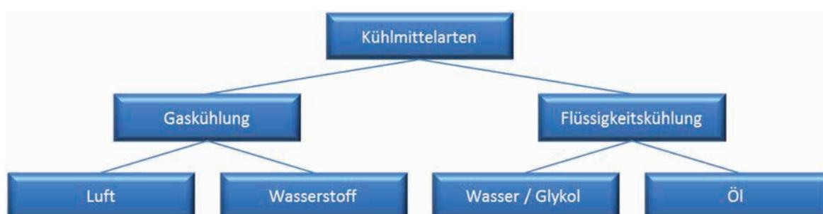
Abbildung 2: Kühlmittelarten elektrischer Maschinen
