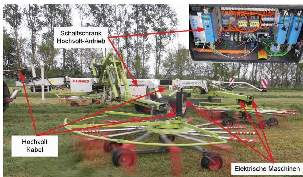
Abbildung 5: Funktionsmuster CLAAS E-Liner 4000
