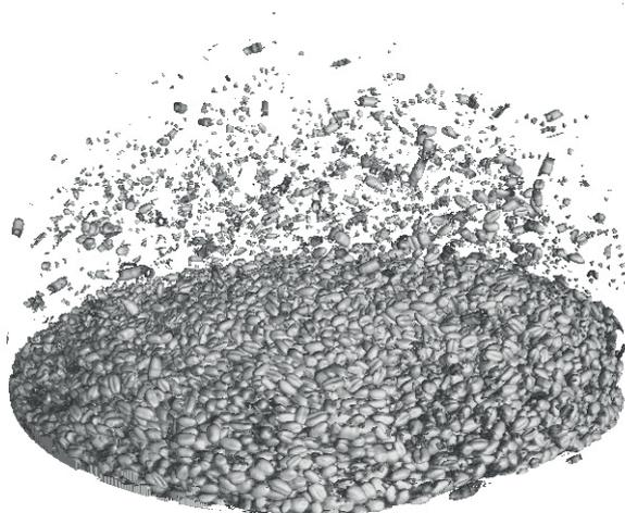
Abbildung 5: Mithilfe der Computertomografie erstelltes 3D-Bild eines Korn-NKB-Gemisches; nur Körner dargestellt
