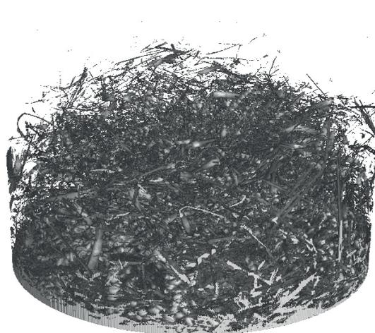
Abbildung 6: Mithilfe der Computertomografie erstelltes 3D-Bild eines Korn-NKB-Gemisches; Darstellung von Korn und NKB
