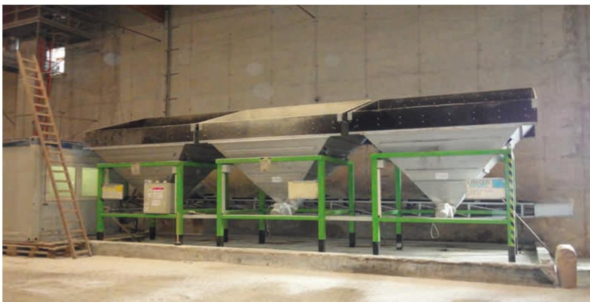
Abbildung 3: Stationäre Düngermischanlage: Trichter links befüllt mit NPK-Complex, Trichter Mitte befüllt mit MOP, Trichter rechts befüllt mit KAS (© J. Pichler)
