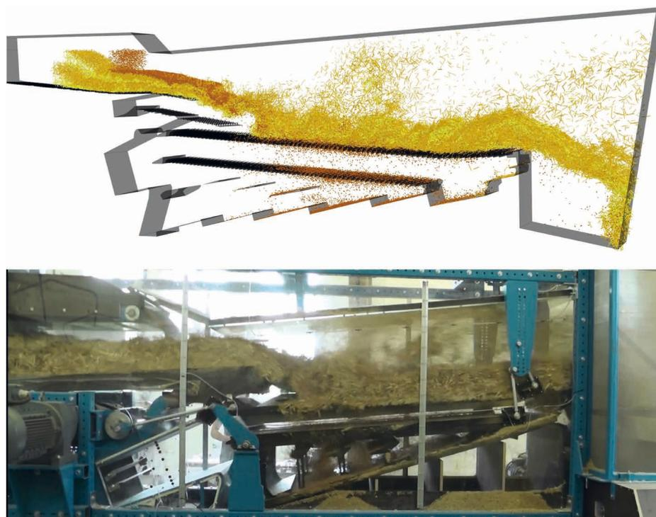
Abbildung 8: Momentaufnahmen des numerischen (oben) und des experimentellen Trennprozesses (unten) in einer Mähdescherreinigungsanlage während der stationären Phase bei einem relativen NKB-Durchsatz  $q_{\text{NKB}} = 2,38 \text{ kg}/(\text{s m})$
