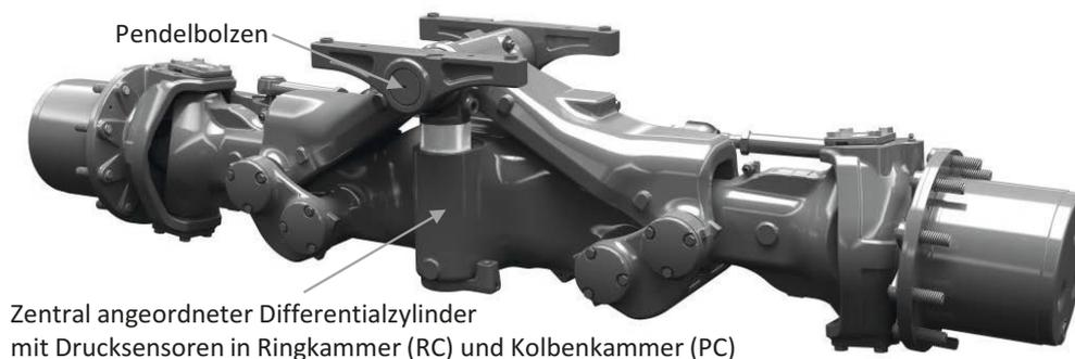
Abbildung 5: Aufbau einer hydropneumatisch gefederten Achse mit einem Federungszyinder mit Druckmesstechnik
