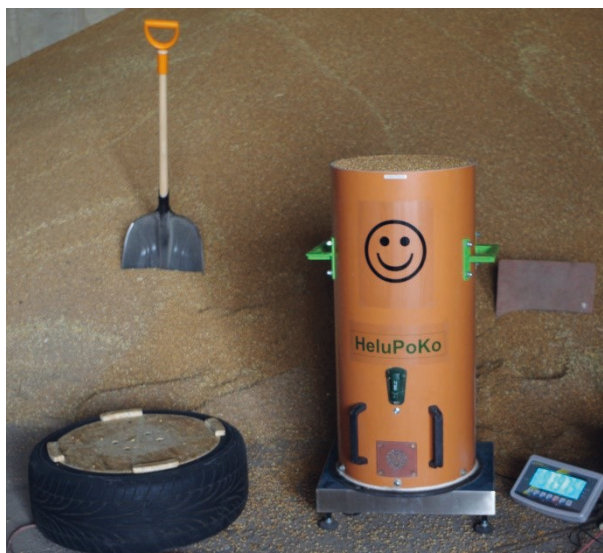
Abbildung 1: 100-l-Gefäß mit Vibrationspodest und Waage zur Bestimmung des Gewichts von 100 l Getreide (© J. Berberich)
