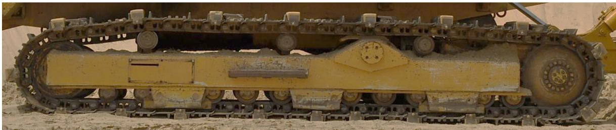
Abbildung 2: Seitenansicht des Laufwerks (© TU Dresden, Lehrstuhl Agrarsystemtechnik)
