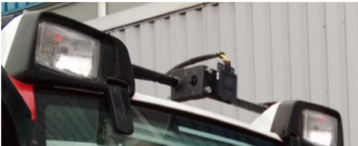
Abbildung 1: Radar montiert an Landmaschine (© ZF Friedrichshafen AG)
