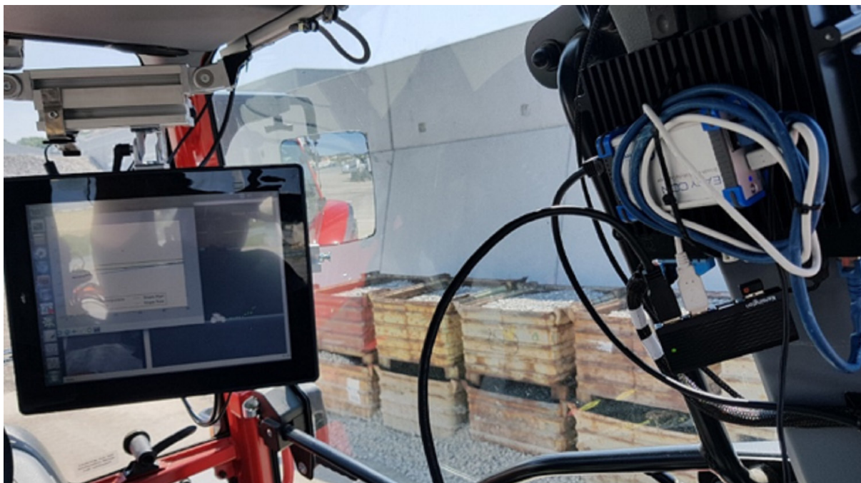
Abbildung 2: Einbau des Systems in Landmaschine: HPC mit Display zur Darstellung der Steigungserkennung (© ZF Friedrichshafen AG)
