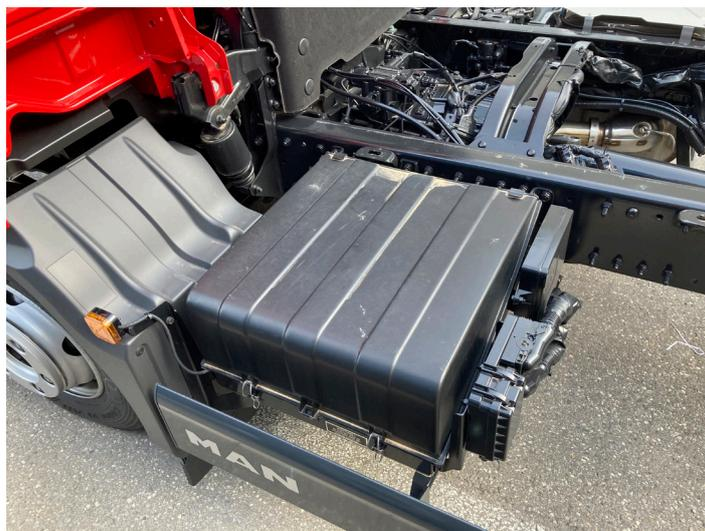
Abbildung 4: An den Rahmen angebundener Batteriekasten eines leichten Lkw der 12-t-Klasse (© MAN)
