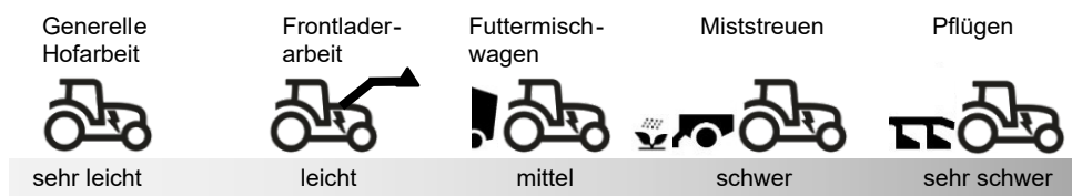
Abbildung 7: Maschinenauslastung anhand eines Traktors
